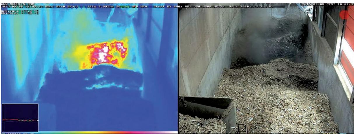
Los buenos sistemas de vídeo pueden detectar automáticamente acontecimientos dentro de un rango de -40 a 550 °C gracias a un sensor térmico y la radiometría térmica.
